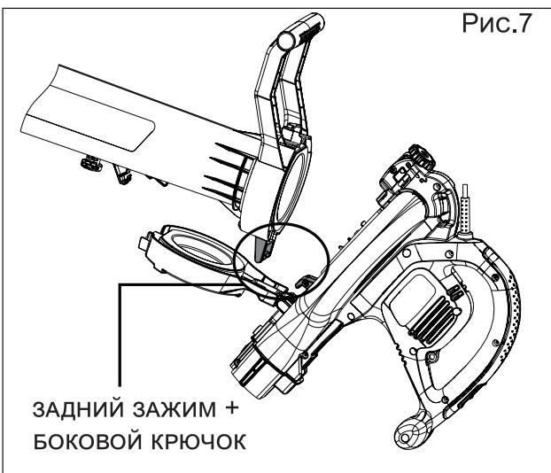
4. Зафиксируйте задний зажим на подсоединеной трубе (Рис.8).
