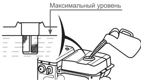
Рис. 5 Максимальный уровень топлива в топливном баке
