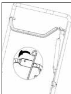
Рис. 2 Установка рычага и троса привода шнека
