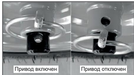
**Рис.26 Перестановка шплинта на левом колесе**
