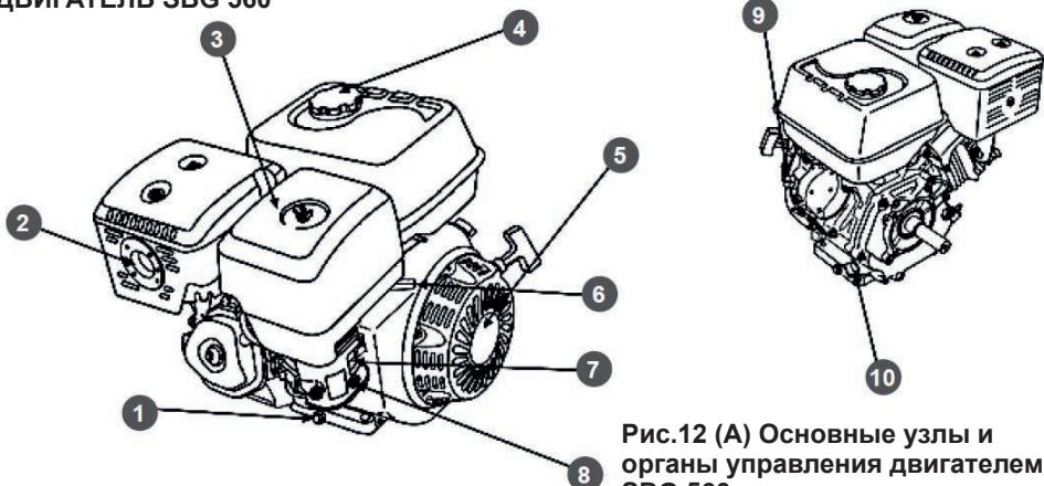
Рис.12 (А) Основные узлы и органы управления двигателем SBG 560
