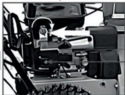
Рис.22 Установка выключателя
