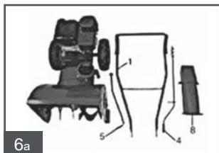
На рисунке 6 (А,Б) показаны крепежные элементы для сборки снегоотбрасывателя.
