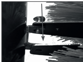
Рис. 6 Соединение отвала и соединительных пластин
