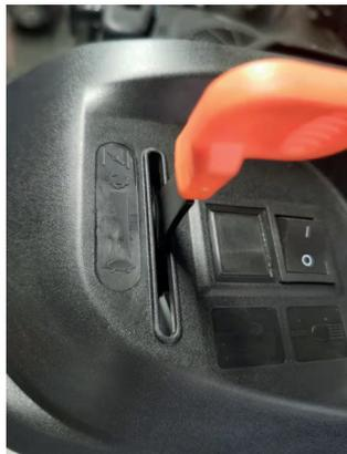
Регулирует обороты двигателя. Положения указаны на табличке со следующими символами :
