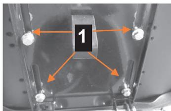
Отрегулируйте сиденье, сдвинув его вдоль пазов кронштейна.
