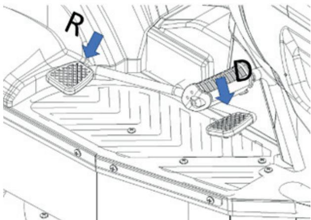
Эта педаль управления скоростью может поворачиваться по 2 раза вперед и назад, при этом передняя передача - это передача опережения «D». Назад - это передача заднего хода «R», а свободная - это нейтральная передача «N».
