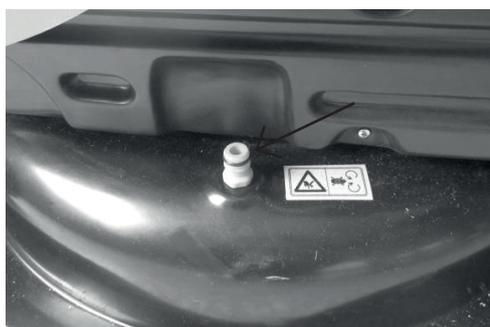
а) При промывке внутренней части косильной деки и коллекторного канала газонокосилка должна находиться на твердом грунте:
