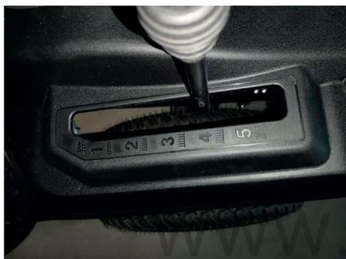
Для этого рычага предусмотрено пять положений, обозначенных на пластине цифрами от «1» до «5», которые соответствуют различным высотам кошения от 3,5 до 7,5 см.
