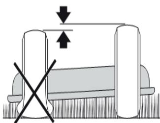
Режущая дека должна быть правильно установлена, чтобы получить хорошее кошение.
