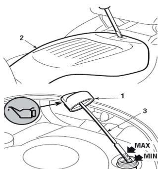
При остановленном двигателе проверьте уровень масла в нем.
