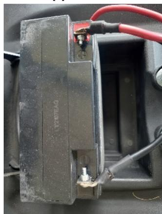
1. Установите аккумулятор вертикально в батарейный отсек под сиденьем.
